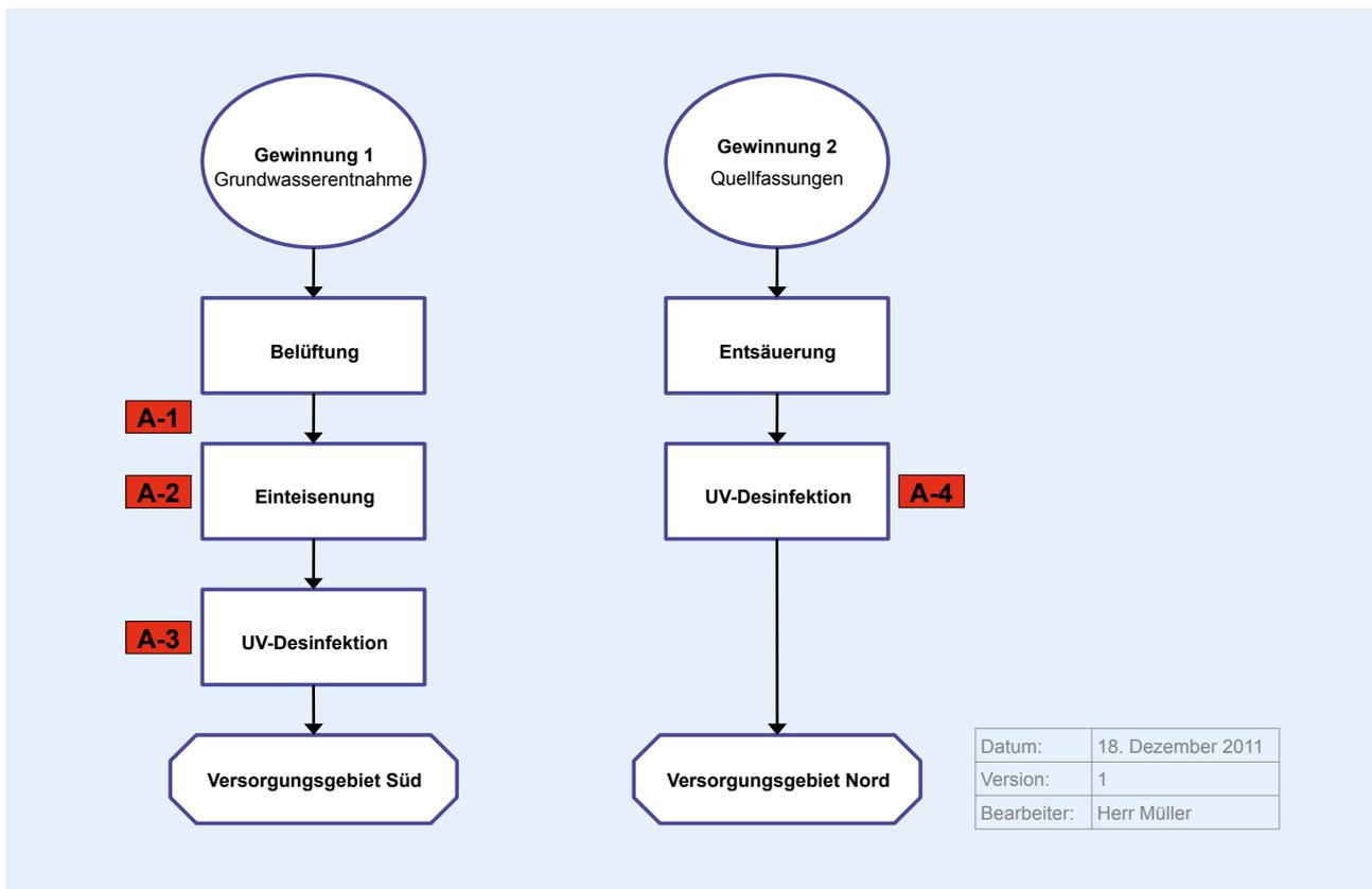
Abbildung 10: Musterversorgung – Aufbereitungsschema mit identifizierten Gefährdungen (nach Tabelle 3)
