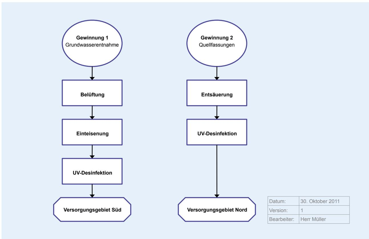
Abbildung 7: Musterversorgung – Aufbereitungsschema
